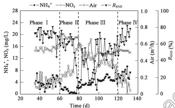
**Fig. 3** Effluent  $\text{NH}_4^+$ ,  $\text{NO}_{\text{x}}$ ,  $R_{\text{SND}}$ , and aeration profiles.
