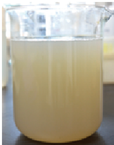
Fig. 1 – S^0 -containing effluent.
