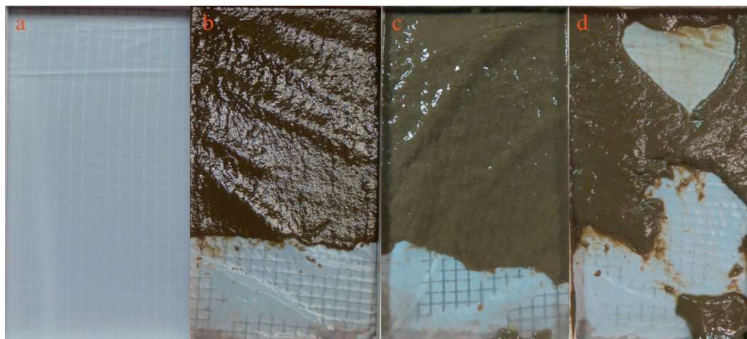
Fig. 5 – Pictures of DM module: (a) new membrane, (b) DM layer of sludge A, (c) DM layer of sludge B, and (d) DM layer of sludge C.
